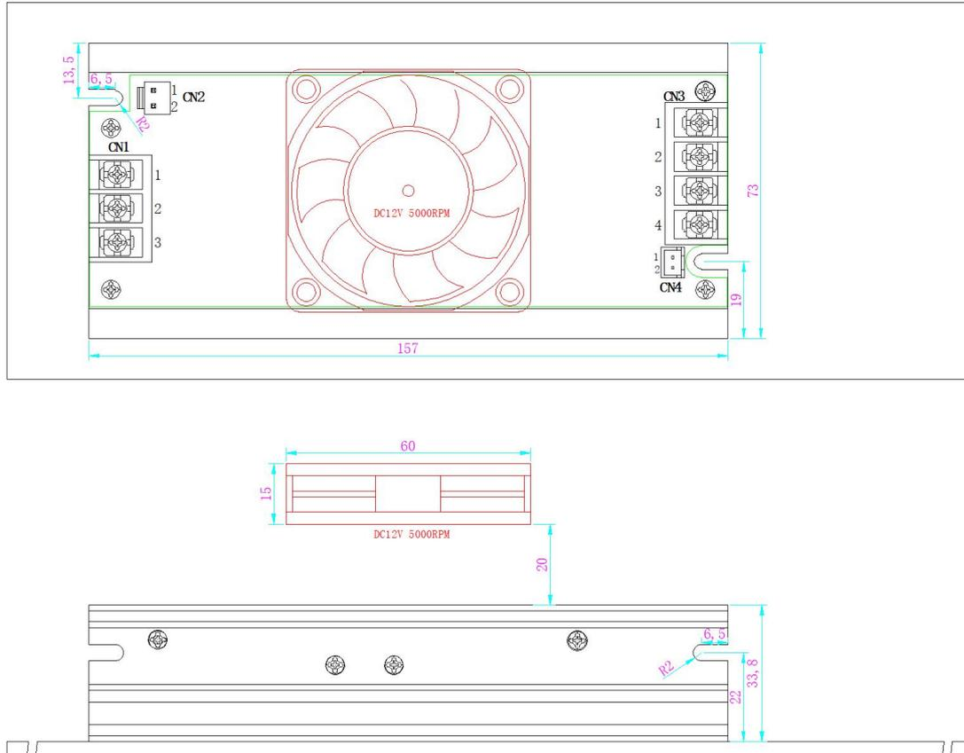
注：直流风扇电压的选择可根据选择的电源电压适配，或选择外部供电电压来适配风扇电压。
