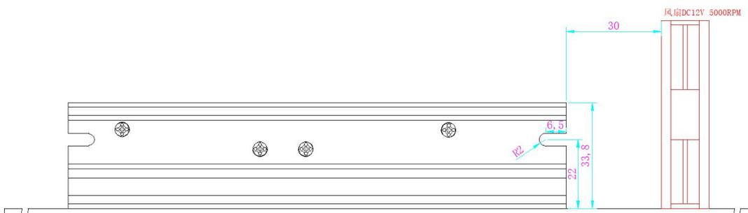
安装方式二：以 60\*15mm DC 12V 5000RPM 风扇为例，将风扇安装于电源中间上方 20mm 处；
